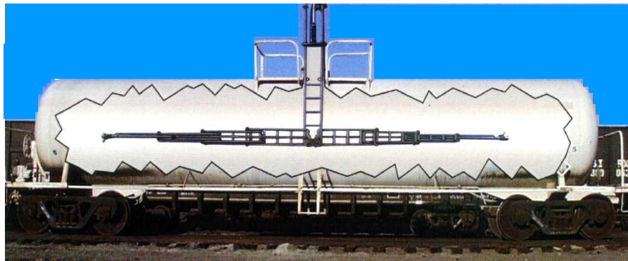
Рис. 2 Развернутая телескопическая система внутри цистерны
