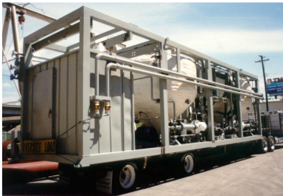
Фото №7. Модульная конструкция, готовая к отгрузке.
