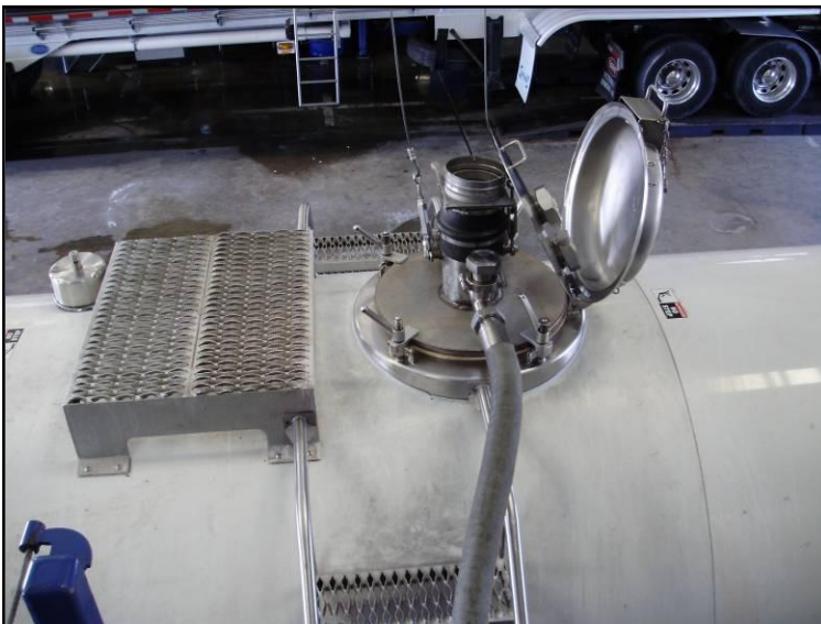
Фото №4 Люковый Адаптер после установки на горловине люка автоцистерны
