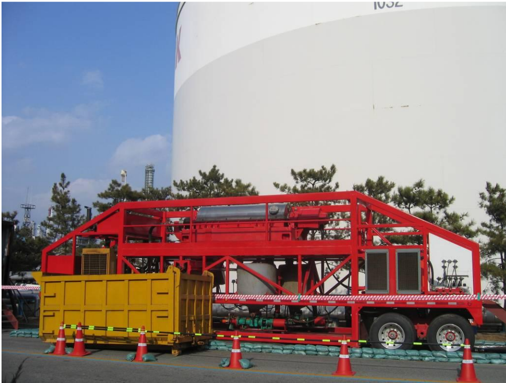
Фото 11. Мобильный блок центрифугирования на рабочей площадке
